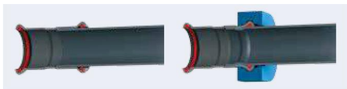
Fig. 1: dwarse doorsnede voor en na het persen
